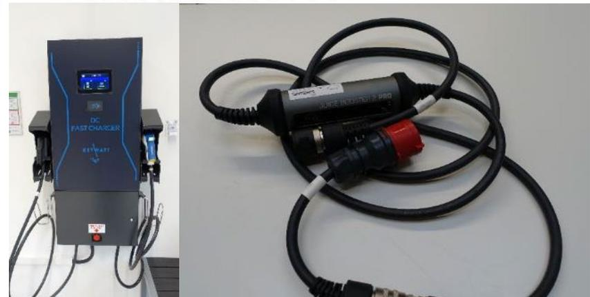
links: ies 24kW Wallbox KEYWATT, die im Technologiecampus Plattling installiert ist und zur Vermessung der Elektrofahrzeuge verwendet wurde; rechts: Die AC-Ladeeinrichtung, die zur Vergleichsmessung verwendet wurde (Technische Hochschule Deggendorf, Technologie Campus Plattling)
